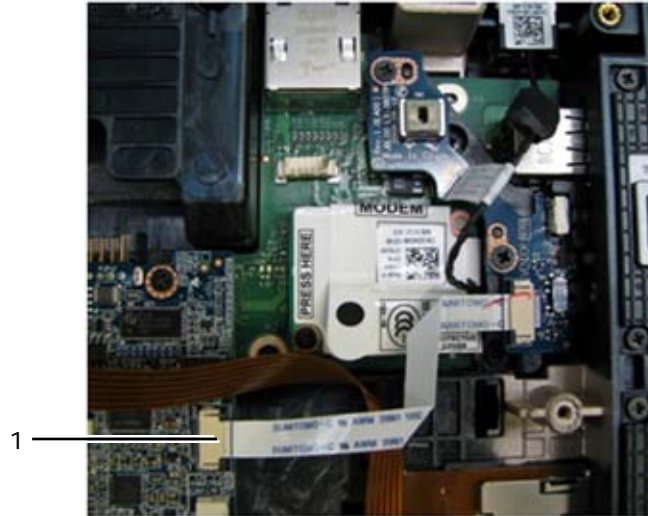
1 Wi-Fi-snifferkabelconnector naar moederbord
