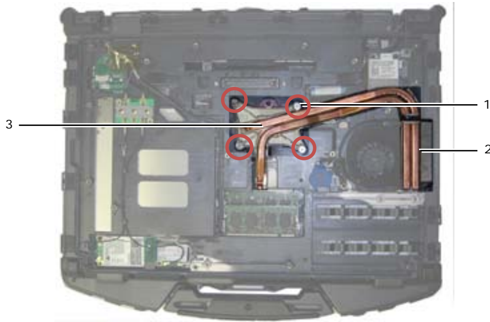
1 Geborgde schroeven (4) 2 Radiator 3 Processorplaat
